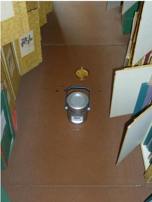
写真7 手前の機器が浮遊菌測定器、奥に落下菌測定用の培地が置いてある状態
