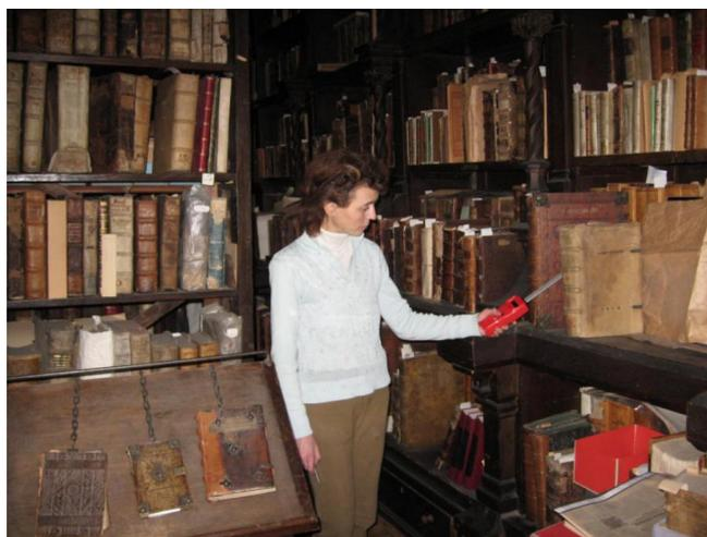
写真3 図書同士の間の温湿度計測の様子
